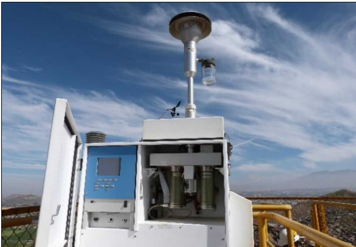
Fotografía 1 Equipo muestreador dicotómico de PM 10 y PM 2,5
